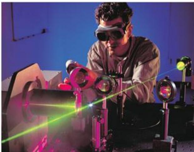
(1) 激光箱及控制台上粘贴警示标识。实验室内墙壁应采用白色漫反射墙壁，在激光易到达处用黑色吸收体，墙壁不要涂油漆。激光束所在的水平面高度应低于 1.2 米。
